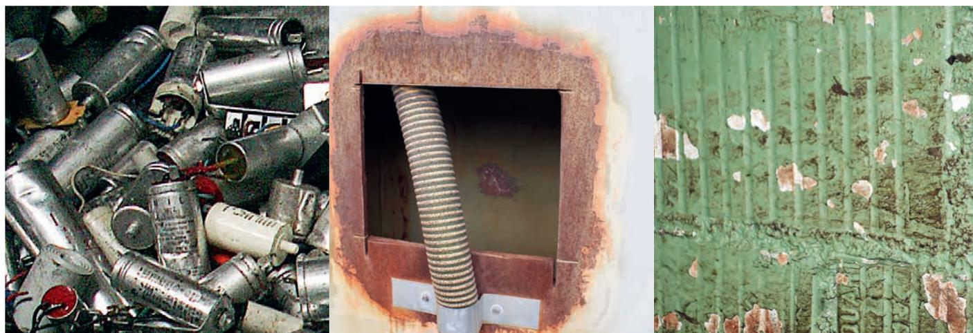
Exemples de condensateurs, de produits anticorrosion et de peintures contenant des PCB. (Photos : EMPA)
